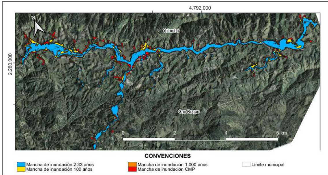
Figura 7.3.3.19 Manchas de inundación para los caudales modelados
