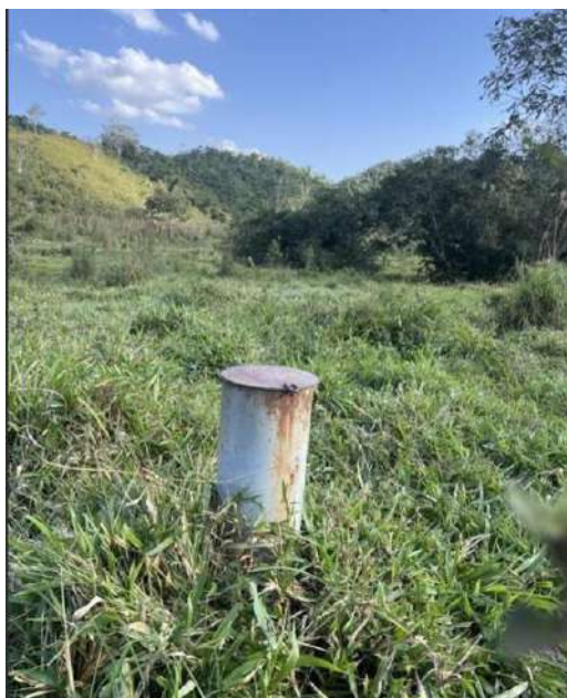
Fotografía 5.1.6.2 Piezómetro PZS 12 12 en el sector del Topacio
