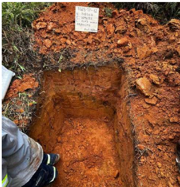
Fotografía 5.1.1.8 Perfil de meteorización del Batolito Antioqueño (sapolito). Apique donde se observa el horizonte del grado V del perfil de meteorización
