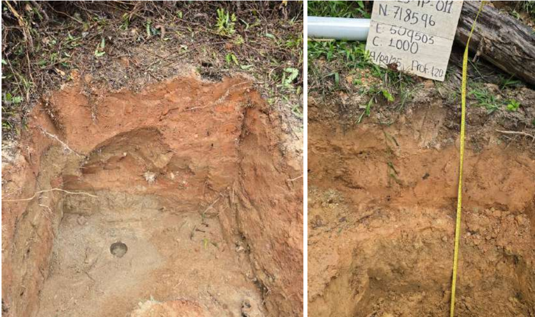
Fotografía 5.1.1.7 Perfil de meteorización de cuarzodiorita del Batolito Antioqueño. A. Horizonte de suelo residual (grado VI) - B Apique, Horizonte del perfil de meteorización (grado VI)
