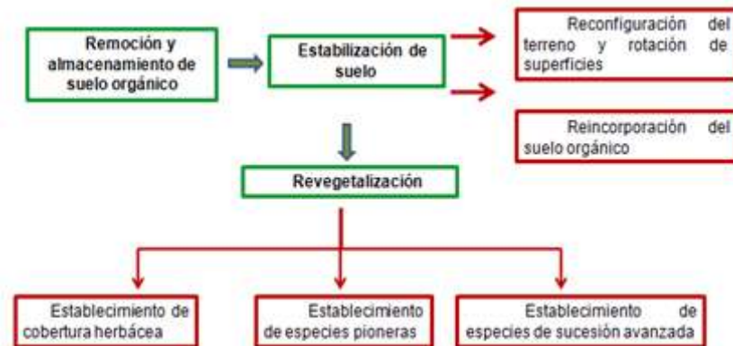
Figura 10.14 Rehabilitación y recuperación de áreas intervenidas.
