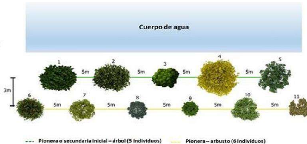
Figura 10.11. Vista de planta: recuperación mediante cordón protector Fuente: Gramalote Colombia, 2024
