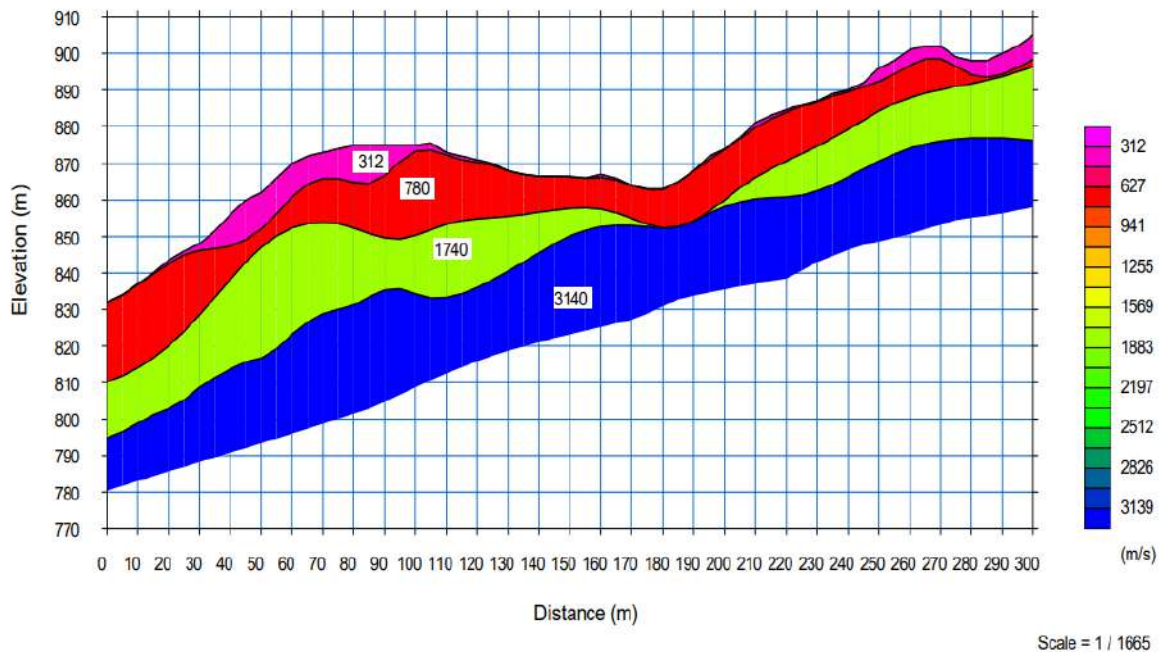
Figura 5.1.1.61 Perfil de velocidad de ondas P de la línea sísmica SRG20-012
