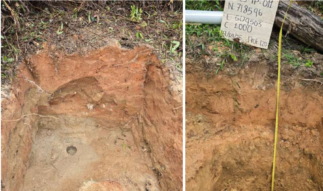
Fotografía 5.1.1.4 Perfil de meteorización de cuarzdiorita del Batolito Antioqueño. A. Horizonte de suelo residual (grado VI) - B Apique, Horizonte del perfil de meteorización (grado VI)
