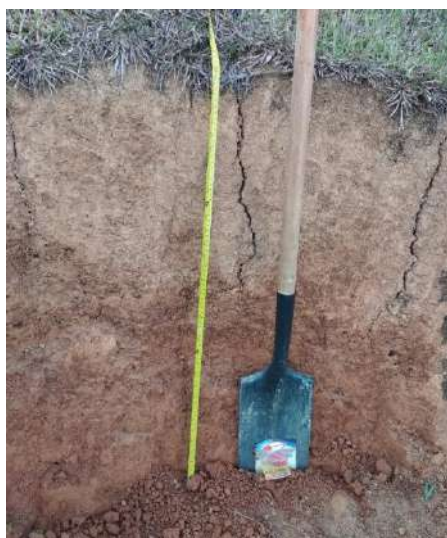
Fotografía 2.10 Descripción de perfiles del suelo por medio de una calicata
