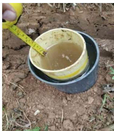
Fotografía 2.13 Medida de la curva de infiltración con la medición
