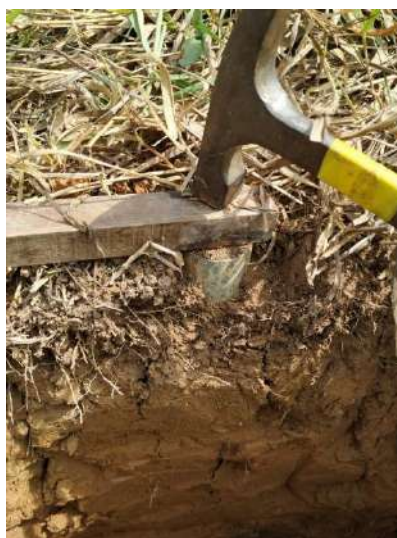
Fotografía 2.11 Uso de cilindro biselado en Calicata
