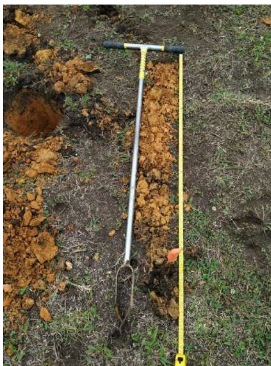
Fotografía 2.3 Construcción del perfil del suelo a partir de los apiques con barreno
