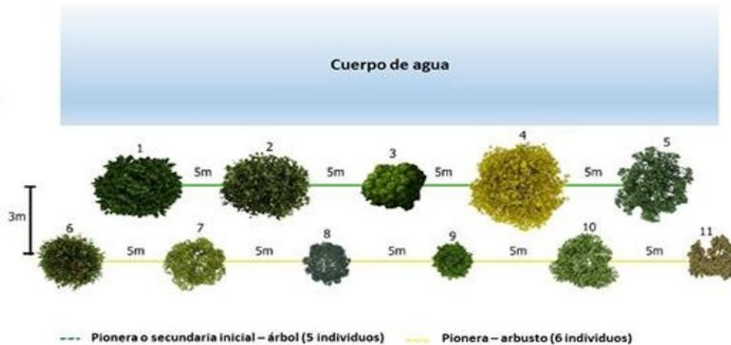
Figura 10.9. Vista de planta: recuperación mediante cordón protector Fuente: Gramalote Colombia, 2024
